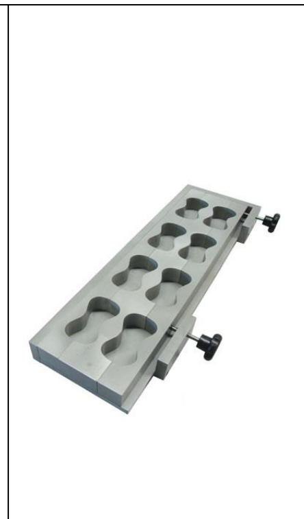
Figura 2 – Foto ilustrativa de uma caixa de macho para cura a frio.
